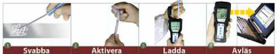
ATP-mätningar på ytor utförs enkelt och snabbt med en Ultrasnap och en handhållen ATP-mätare.
